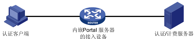
图1-2 使用本地 Portal 服务器的 Portal 系统组成示意图
